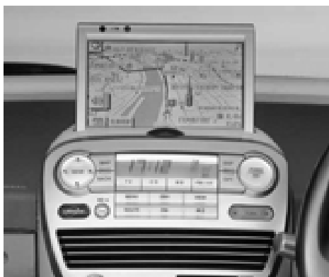
Rys. 13.19. Trasa pojazdu wyświetlana na ciekłokrystalicznym monitorze [26]
