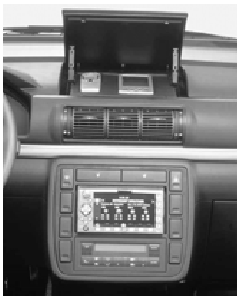
Rys. 13.10. Panel sterowania komputerem pokładowym odpowiadającym standardowi PC z ciekłokrystalicznym kolorowym wyświetlaczem [26]
