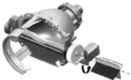
Rys. 12.16. Reflektor Vario-Xenon firmy Hella
