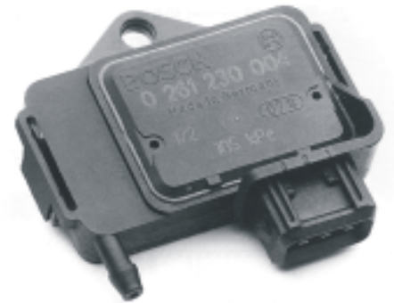
Rys. 2.25. Wygląd czujnika ciśnienia układu sterowania wtryskiem wielopunktowym [9].
